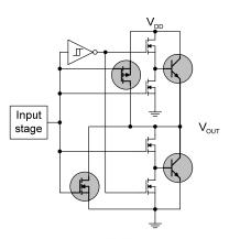
Figure 31. MillerDrive<sup>™</sup> Output Architecture
