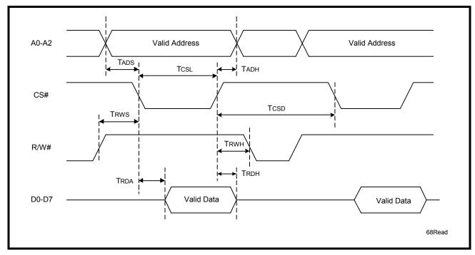
FIGURE 15. 68 MODE (MOTOROLA) DATA BUS WRITE TIMING - PARALLEL MODE
